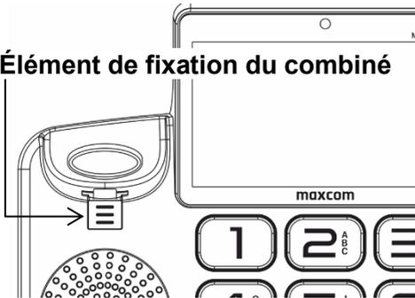
Retirez l'élément de fixation du combiné et insérez-le de nouveau dans un sens inverse de manière à pouvoir maintenir le combiné en position verticale
