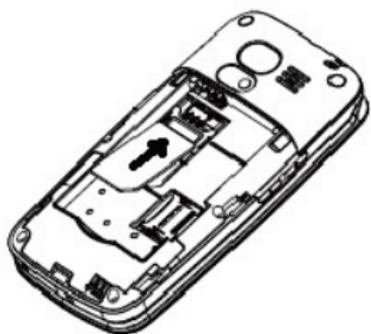
⊖ Pored utora za SIM karticu nalazi se mjesto za microSD memorijsku karticu. Premjestite klizač prema strani OPEN, a zatim ga podignite gore. Umetnite microSD tako da kontakti microSD kartica dodiruje kontakte telefona, zatvorite klizač u smjeru *LOCK*
