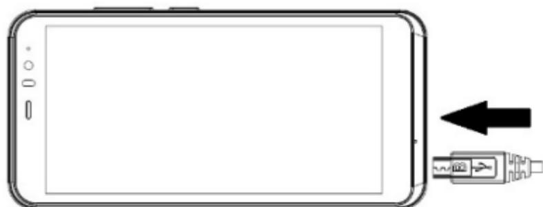
3. Cuando la batería esté completamente cargada, desconecte el cargador de la toma de corriente y, a continuación, desconecte el cable del teléfono.
